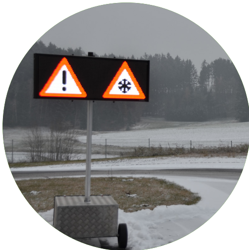
Mobiles Informationssystem im Einsatz für Gefahrenprävention im Straßenverkehr
